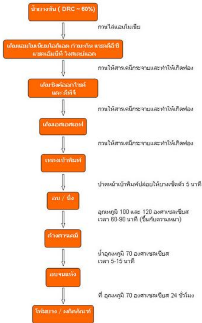
ขั้นตอนการผลิตโฟมยางพาราด้วยกระบวนการ Dunlop Process
